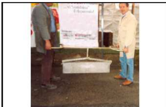
Pinza meccanica per trasporto manuale a due persone
