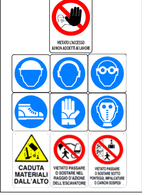
CARTELLI DA INSTALLARE ALL'INGRESSO DELLA ZONA DI CANTIERE RECINTATO
