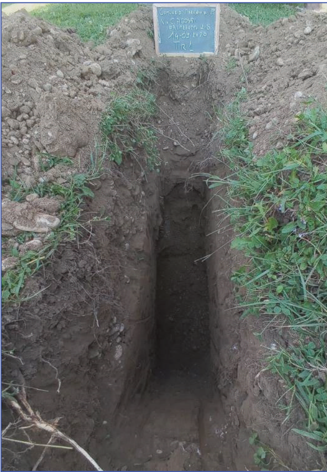
TRINCEA GEOGNOSTICA Tr1
