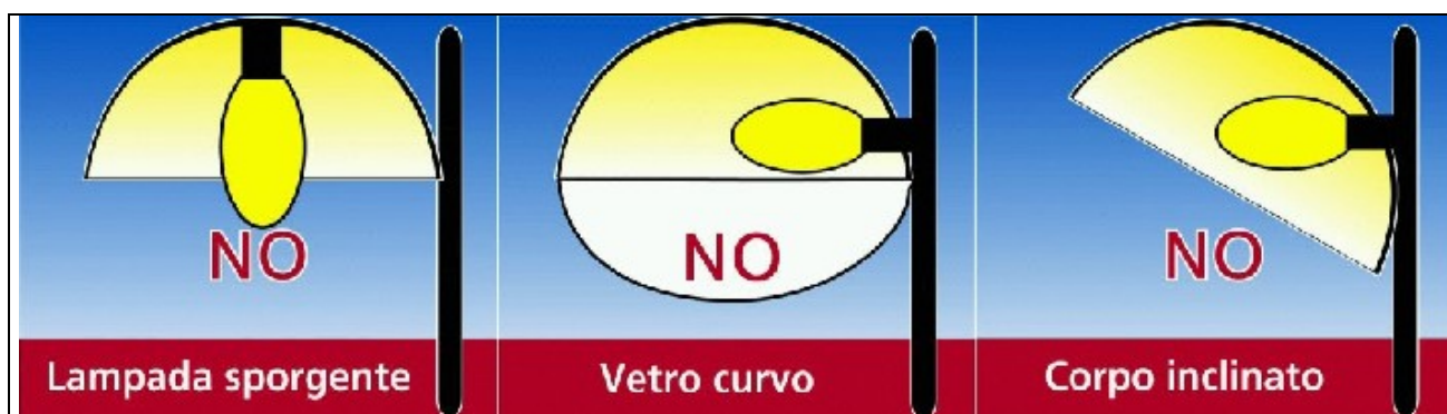
Figura 2.1 – Tipologie di apparecchi non ammessi (cortesia: CieloBuio)
